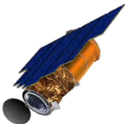
Il satellite OrbView-3 (2001) è uno dei primi satelliti commerciali che fornirà immagini ad alta risoluzione dallo spazio. OrbView-3 produrrà immagini pancromatiche ad un metro di risoluzione e immagini multispettrali a 4 metri.
